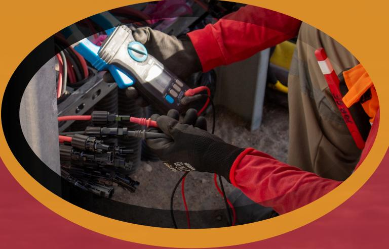
Prueba de resistencia de aislamiento (megado): Verifica que los cables no presenten fugas de corriente.
