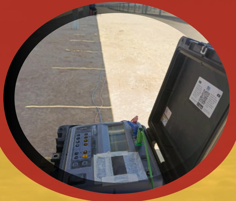
**Prueba de disparo de diferenciales: Realizamos el disparo de diferenciales para asegurar su correcto funcionamiento y protección del sistema.**
